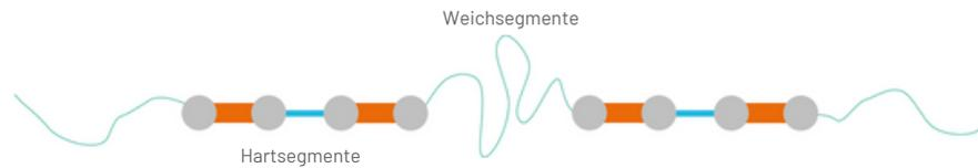
Abbildung 2: Schema einer Polymerkette mit Hart- und Weichsegmenten
