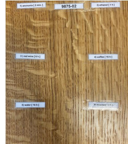
Abbildung 3: Beständigkeitsprüfungen auf Holz
